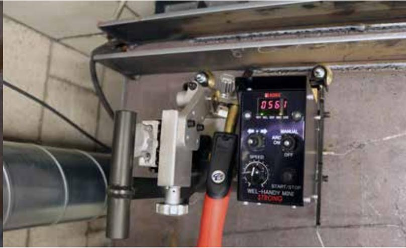
**Wel-Handy Mini Strong** è un carrello saldatura dal design compatto progettato per eseguire saldature orizzontali, verticali, e a sbalzo. Un robusto magnete da 35 kg e uno sforzo di trazione di 16 kg assicurano prestazioni affidabili e saldature di qualità.
