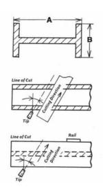
La **Mini-Mantis II** proporciona cortes diagonales de alta precisón que son limpios y nítidos. Dos motores mueven la antorcha tanto para el corte de alma y de la brida. No hay necesidad de girar y marcar la pieza de trabajo.
