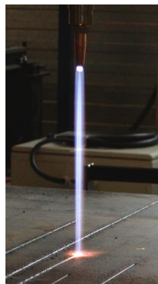
Potente flusso di ossigeno da taglio da una punta divergente: Foto scattata del test prestazionale interno Koike. Punta ugello a 275 mm sopra la lamiera, punta 106-D7#0.
