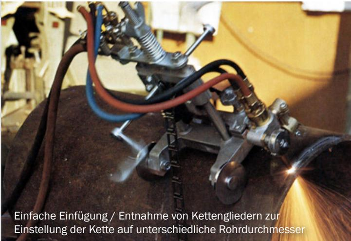
Einfache Einfügung / Entnahme von Kettengliedern zur Einstellung der Kette auf unterschiedliche Rohrdurchmesser
